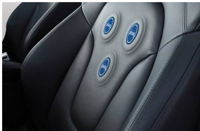
Rysunek 2.5: Sensory do badania sygnałów fizjologicznych zamontowane w fotelu kierowcy (Źródło: [7])
